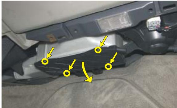
**PL** Odkręcić wkręty mocujące pokrywy komory filtru. Usunąć pokrywę filtru
